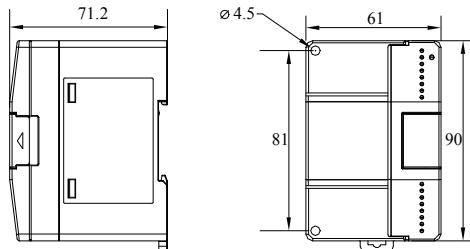
图 6-6 I/O 扩展模块与特殊功能模块外形与安装尺寸 (单位: mm)
