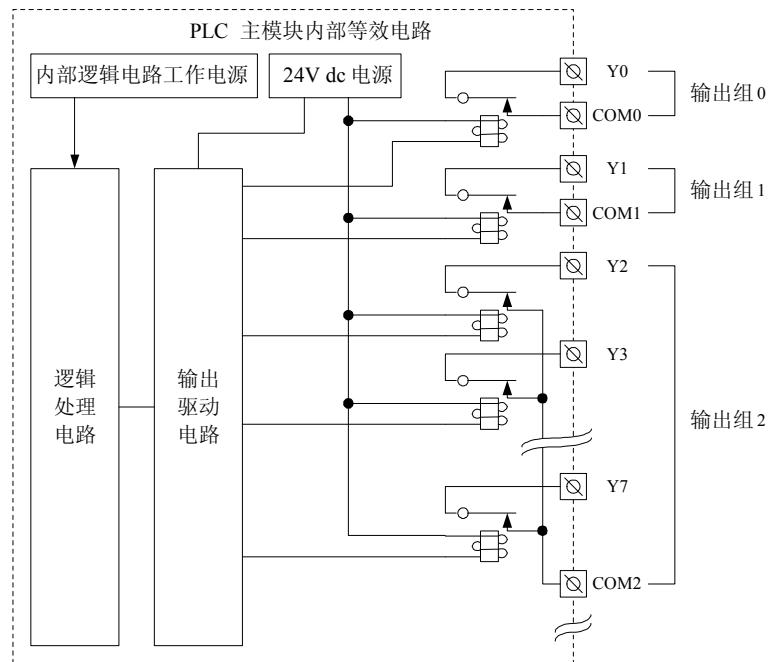
图 4-24 继电器输出型 PLC 输出部分内部等效电路
