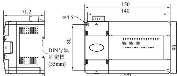
图 6-3 EC10-1614BRA 及 EC10-1614BTA、EC10-1614BRD、EC10-1614BTD 的外形与安装尺寸 (单位: mm)
