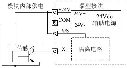
图 4-19 使用模块内部电源的漏型输入接线图
