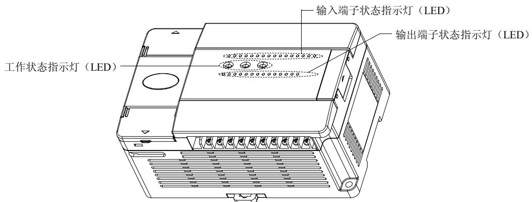
图 4-28 主模块状态指示灯位置示意
