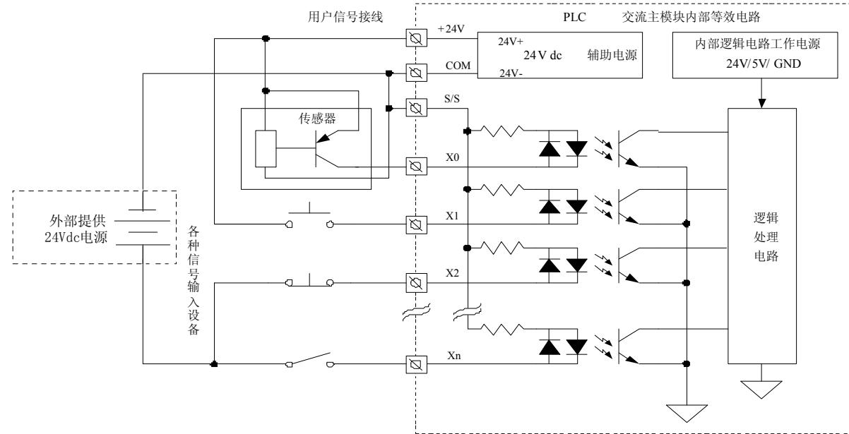
图 4-14 源型输入方式的交流主模块内部等效电路
