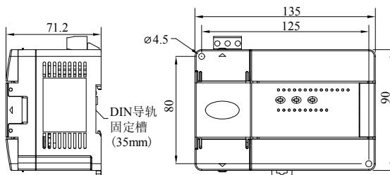
图 6-2 EC10-1410BRA、EC10-1410BTA、EC10-1410BRD、EC10-1410BTD 的外形与安装尺寸（单位：mm）
