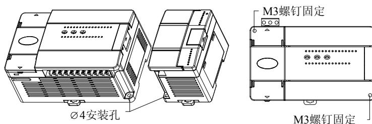
图 6-9 采用螺钉安装固定
