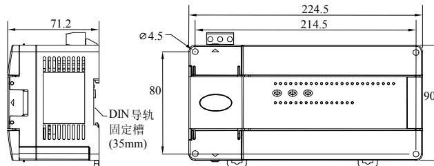
图 6-5 EC10-3624BRA、EC10-3624BTA、EC10-3624BRD、EC10-3624BTD 的外形与安装尺寸 (单位: mm)
