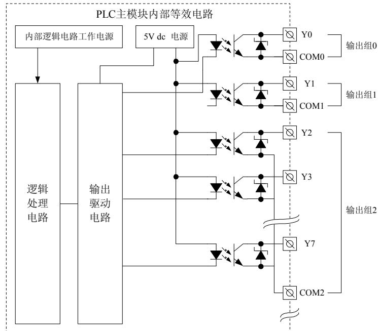
图 4-26 晶体管输出型 PLC 输出部分内部等效电路
