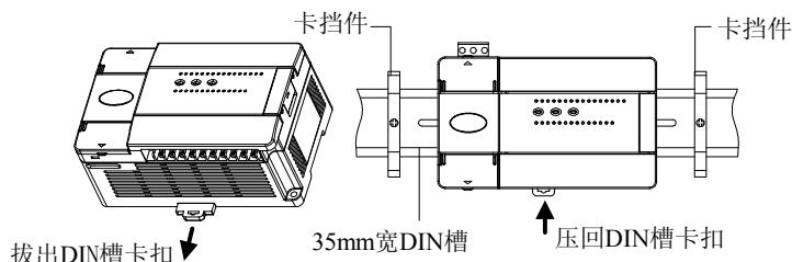
图 6-8 采用 DIN 槽安装固定
