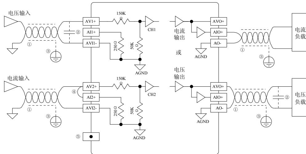
图 4-29 模拟量输入输出部分内部等效电路
