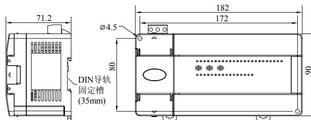
图 6-4 EC10-2416BRA、EC10-2416BTA、EC10-2416BRD、EC10-2416BTD、EC10-1614BRA1、EC10-1614BTA1 的外形与安装尺寸 (单位: mm)
