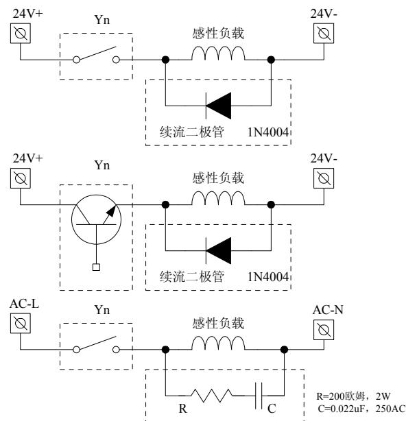
图 4-25 PLC 输出触点的保护电路
