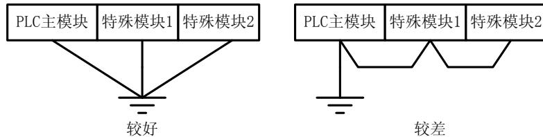
图 6-13 PLC 主模块与特殊功能模块电源接地线连接示例
