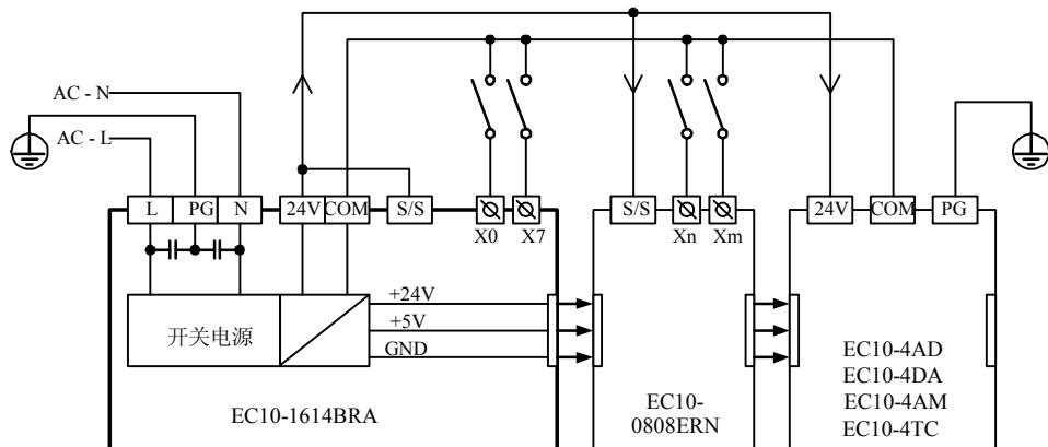
图 6-11 交流电源及辅助电源连接示例
