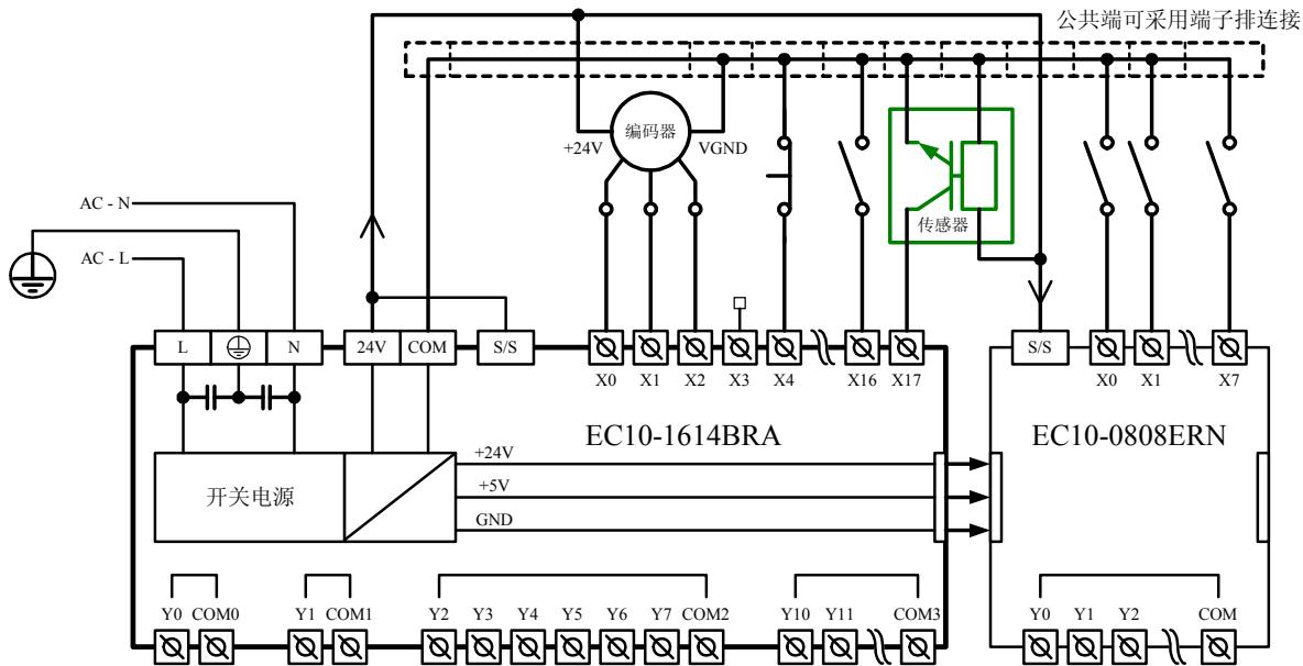
图 4-23 EC10-1614BRA 与 EC10-0808ERN 的电气连接示例
