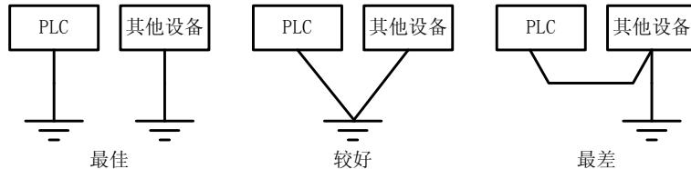
图 6-12 PLC 与其它设备电源接地线连接示例
