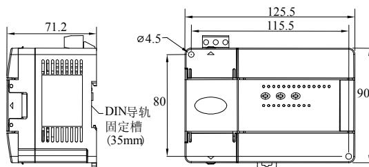
图 6-1 EC10-1006BRA、EC10-1006BTA、EC10-1006BRD、EC10-1006BTD 的外形与安装尺寸（单位：mm）
