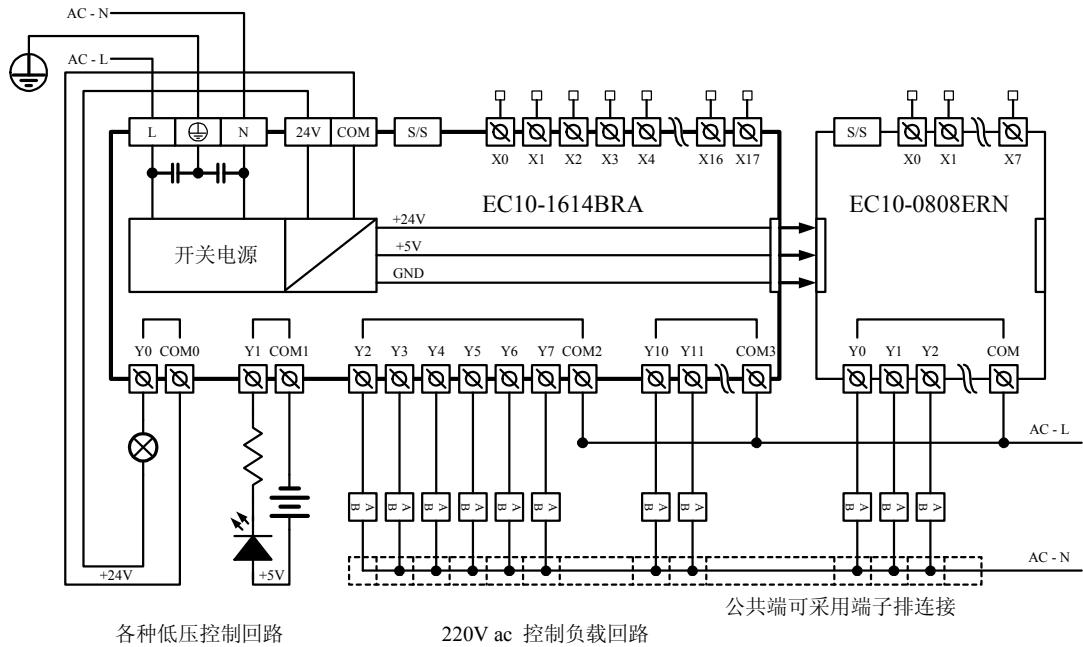
图 4-27 EC10-1614BRA 与 EC10-0808ERN 的电气连接示例
